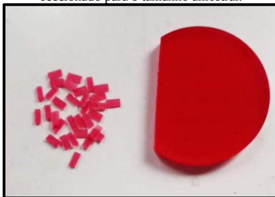
Figura 8. Disco PMMA de resina compactada VIPI-BLOCK-VIPI (Pirassinunga, São Paulo, SP, Brasil) seccionado para o tamanho amostral.
