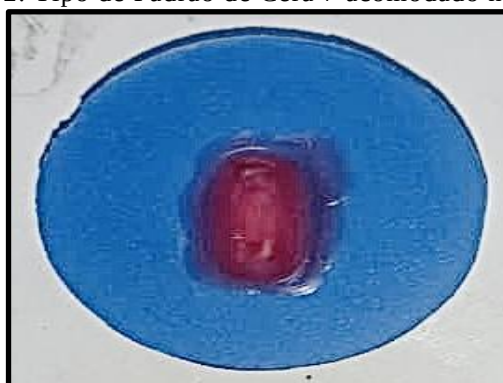
Figura 2: Tipo de Padrão de Cera 7 acomodado no molde
