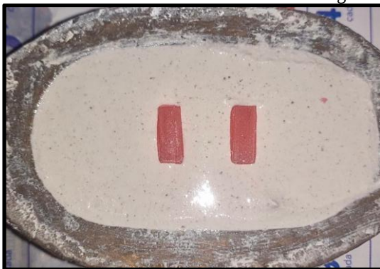
Figura 4. Padrão de cera sendo incluído na mufla com gesso justaposto.
